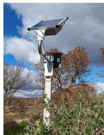
Con riferimento alla figura a lato il dispositivo è stato installato, tramite fascette, su alberi esposti al sole ed alimentato da un piccolo pannello fotovoltaico.
